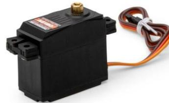
La troisième broche accepte le signal de commande qui est un signal de modulation de largeur d'impulsion (PWM). Il peut être facilement produit par tous les microcontrôleurs et la carte Arduino. Celui-ci accepte le signal de votre contrôleur qui lui indique l'angle vers lequel tourner. Le signal de commande est assez simple par rapport à celui d'un moteur pas à pas. Ce n'est qu'une impulsion de différentes longueurs. La durée de l'impulsion correspond à l'angle de rotation du moteur.
